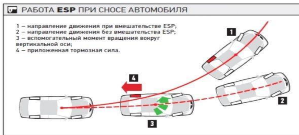
Рисунок 3 – Принцип работы системы курсовой устойчивости
